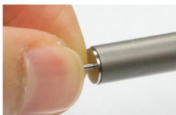
15. ソケットレンチにはマグネット機能があり、インサージョンスクリューを所定の位置に確実に固定します。
