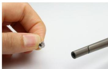
14. インサージョンスクリューをプライヤーのソケットレンチに取り付けます。
