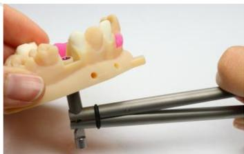
9. プライヤーをゆっくり握るとプリンティングモデルアナログはモデルソケットの中の正しい位置に引き寄せられます。
